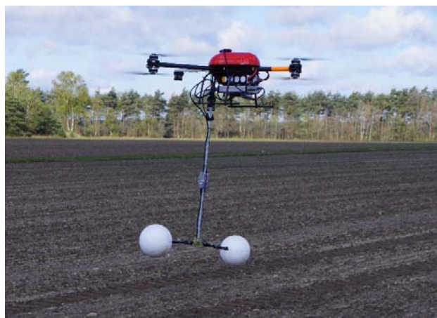
Abbildung 1: Drohne mit dreikomponentigen Gradiometersystem.
