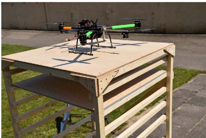
Abbildung 1: Multikopter auf dem unmagnetischen Teststand.
